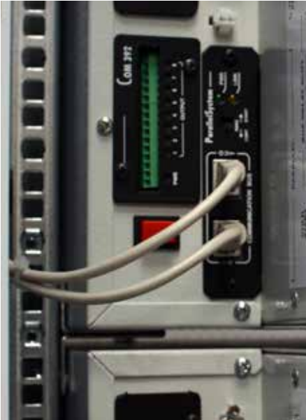
Parallelanschluss und Platine mit programmierbaren Relaiskontakten
